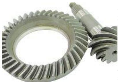
Адаптация коробки передач к конкретному двигателю и автомобилю осуществляется с помощью **главной передачи**, имеющей определенное передаточное число. В этом **основное предназначение главной передачи** автомобиля.
