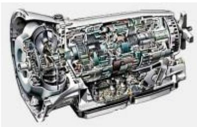
Комбинированный принцип действия используется в автоматической коробке переключения передач (сокращенное наименование – АКПП, обиходное название – коробка-автомат). Классическая **автоматическая коробка передач** включает гидротрансформатор (заменяющий сцепление и обеспечивающий безступенчатое
