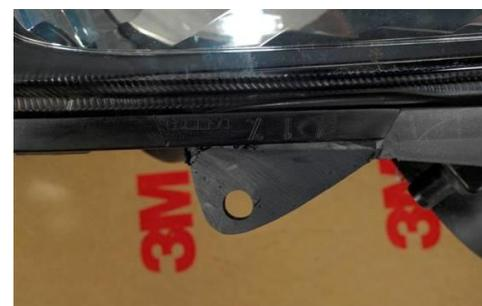
Через 5 минут 3М 55045 Клею для быстрого восстановления можно придать форму и размер (шлифовать, резать, сверлить отверстия)
